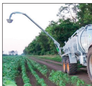
Rotatie en opheffen door hydraulische cilinders.
