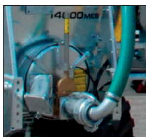
Aansluiting op de afsluiter en snelle aankoppeling van de strooikegel.
